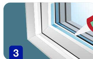
使用双棒或气密型填缝枪。将胶水挤入所需的凹槽以填充凹槽。
