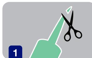
切掉墨盒螺纹端的顶部和塑料尖端以 45 度角切割，并将塞子连接到管上。
