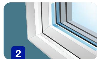
使用遮蔽胶带覆盖接缝的侧面，这样在填充接缝时多余的不会溢出接缝。
