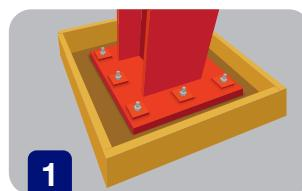
浇注座成型，复查无渗漏，固定支撑牢固。
