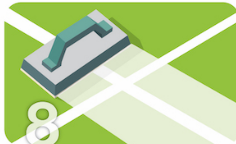
ทิ้งไว้ 24-48 ชม. ก่อนใช้ยาแนวอะครีลิกให้ถูกต้องประเภท ใช้กาวซีเมนต์หรือปูนทรายให้ถูกต้องประเภท ทิ้งไว้ 72 ชั่วโมง ก่อนเปิดใช้พื้นที่
