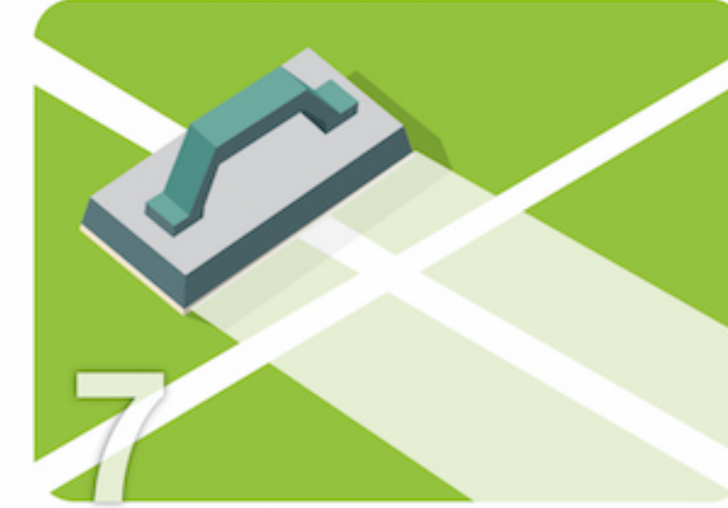
ทิ้งไว้ 24-48 ชม. ก่อนใช้ยาแนวจระเข้ ให้ถูกประเภท ใช้เกรียงยางปาดยาแนวจระเข้ ให้เต็มร่องตามมเดียวกับร่องยาแนว ทิ้งไว้ 72 ชั่วโมง ก่อนเปิดใช้พื้นที่
