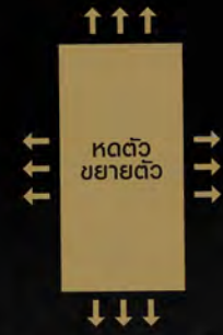
3. การหดตัว และยืดขยายตัวของกระเบื้อง Big Slab ที่เกิดจากอุณหภูมิและสภาพอากาศ
